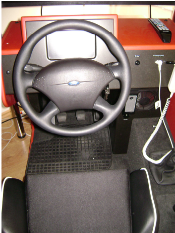
3. ábra: Egy vezetéstechnikai szimulátor belső kialakítása
