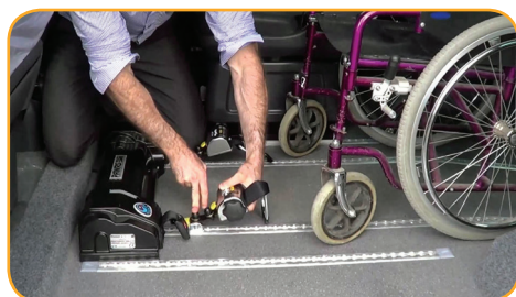
3. kép: Univerzális, profilsínes, négyponos lehoronyzó rendszer. Forrás: www.uniwin-safety.com
